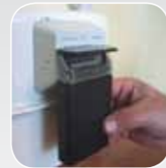
OPTIKAI LEOLVASÓ ADATAINAK TOVÁBBÍTÁSA GPRS-EN
